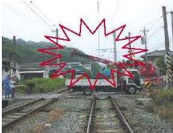
▲ クレーンのブームを伸ばしたまま踏切を通過し架線に触れ感電
