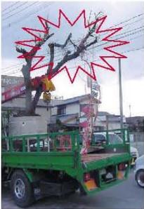
◀ 積荷の高さオーバーで架線に触れ感電
