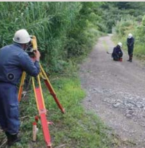
位置や高さの基準となる基準点・水準点を設置します。
