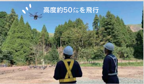
水平位置と標高の基準になる標定点・検証点は飛行が終われば撤去。天候条件に注意し、機器の落下がないよう作業します。
