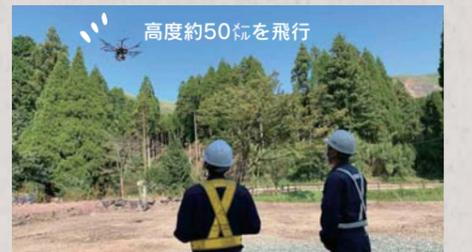
水平位置と標高の基準になる標定点・検証点は飛行が終われば撤去。天候条件に注意し、機器の落下がないよう作業します。
