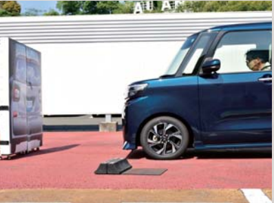
サボカー体験 ブレーキを踏まずに止まる 衝突回避支援ブレーキ機能を体感
