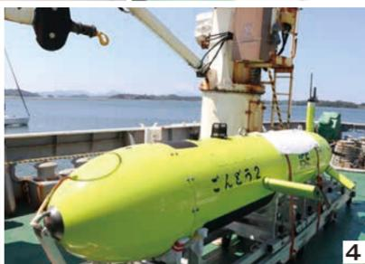
1 三角港に初入港した大型測量船「拓洋」 2 3Dメガネを使って日本列島近海の海底地図の様子を観察 3 普段入ることのできない操舵室で職員からレーダー機器の説明を受ける参加者 4 海上保安庁に所属する測量船7隻のうち2隻しか搭載していない自律型潜水調査機器
