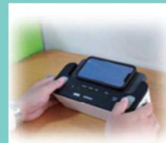
本体左右の電極に両手の指を接触させることで心電図を記録
