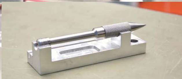
名工学科中級コースで製作するボールペンとペン置き 右の穴はペンが絶妙に立つよう100分の1 3 の精度
